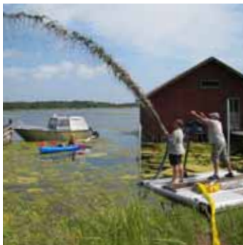
1. Pumpens kapacitet demonstreras tydligt, nästan 1000 liter dyvatten i minuten pumpas upp. Samma pumpar används även för gödselspridning.
